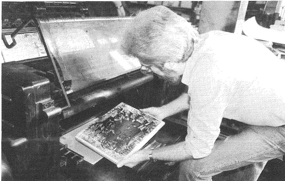
In der Druckerei Aeschlimann wird der Holzstempel in den ehrwürdigen «Original Heidelberg Zylinder 1925» eingelegt.
